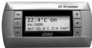
Das grafikfähige Display zeigt Informationen wie Betriebsmodus des Geräts, Status des Ventilators, Sollwert, Prozent Frischluft oder Außenlufttemperatur an.
