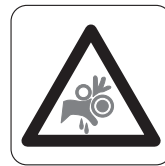
Verletzungsgefahr durch drehende Teile
