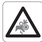
Verletzungsgefahr durch drehende Teile
