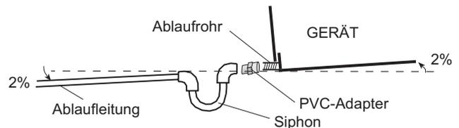
Bauen Sie einen Siphon ein, um ein Ansaugen durch die Ventilatoren zu verhindern.
