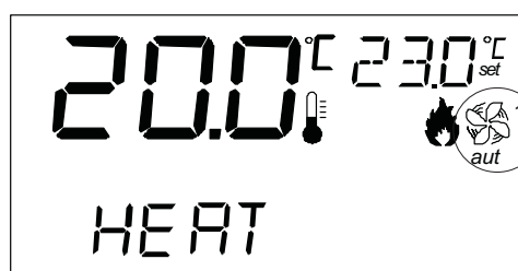
Werkingsmodi van de ventilator
