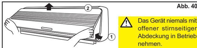
Die Haken oben an der Abdeckung in die Bohrungen des Gitters einhaken und beide unteren Seiten der Abdeckung andrücken. Daraufhin schnappt die Abdeckung in ihrem Sitz ein.
