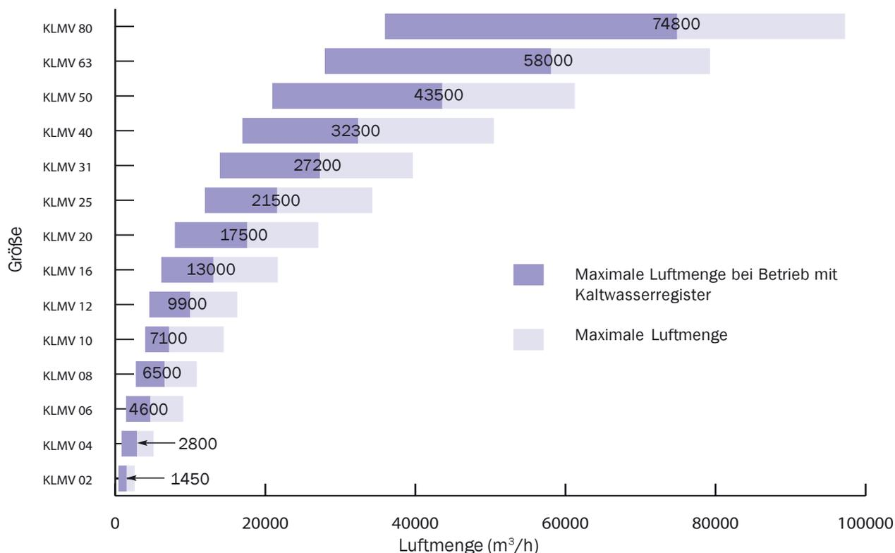
Bemerkung : Die obenstehende Tabelle gibt die maximale und minimale Luftmenge für jeden Gerätetypen an. In der Grafik sind die maximalen Luftmengen bei Betrieb mit Kaltwasserregistern eingetragen
