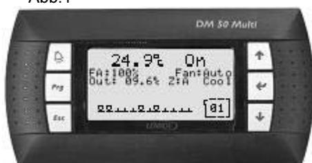
In der untersten Zeile des BM50 zeigt das Symbol '→' die am pLan-Bus erkannten BM50 an (Nummer 1 links, bis Nummer 12 rechts) Ein abgeklemmtes oder ausgeschaltetes Gerät kann am DM50 nicht angezeigt werden.
