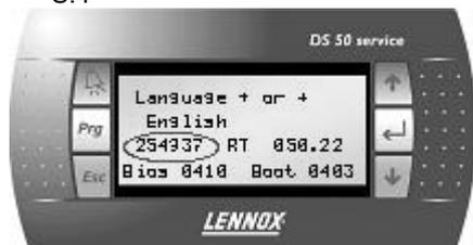
Bei einem spezifischen Programm für einen Auftrag (NSR) wird dieses im Display durch eine Herstellernummer links von der Programmversion kenntlich gemacht (S.4).
