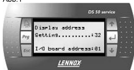
Zugriff auf den Konfigurationsmodus durch Drücken von ↑ ↓ ←
