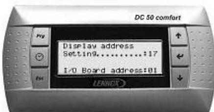
Zugang zum Konfigurationsmodus durch gleichzeitiges Drücken von ↑ ↓ ← für mindestens 5 Sekunden, bis der Bildschirm Abb.1 erscheint. 'Enter' drücken, um den Cursor auf die Zeile 'Setting' zu bewegen. Mit ↑ oder ↓ die Adresse des Displays einstellen. Für DC50 siehe die folgende Tabelle, DM50 ist immer 31, mit ← bestätigen.
