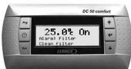
Bei einem Filteralarm am Gerät wird der Bildschirm Abb.8 angezeigt.
