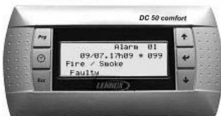
Die Taste 'Alarm' drücken, um nach Möglichkeit sämtliche Alarme zurückzusetzen.
