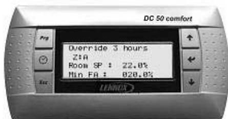
Im Bildschirm Abb.4 werden die Aufhebungswerte verändert. Die aktuelle Zeitzone wird in der 2. Zeile angezeigt. Diese Zone bleibt 3 Stunden lang fest.
