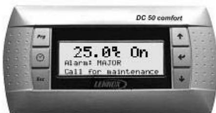
Bei einem Fehler am Gerät wird der Bildschirm Abb.9 angezeigt.
