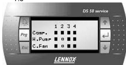
T.5 Kondensator, Verdichter und Ventilatoren
