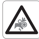
Verletzungsgefahr durch drehende Teile
