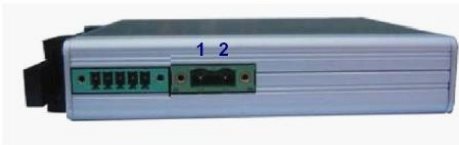
Figuur 10: Adalink aansluiten via female connector (meegeleverd)
