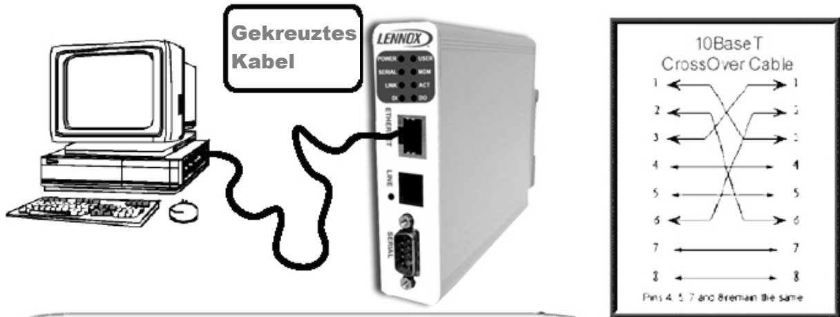
Direkte Verbindung PC zu eWON über ein gekreuztes RJ45-
