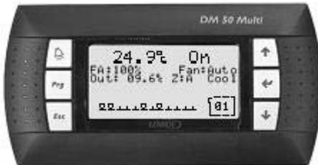
In der Fußzeile des BM50 gibt das Symbol '→' an, dass die BM50 vom pLan-Bus erkannt wurden (Nummer 1 links, bis Nummer 12 rechts).
