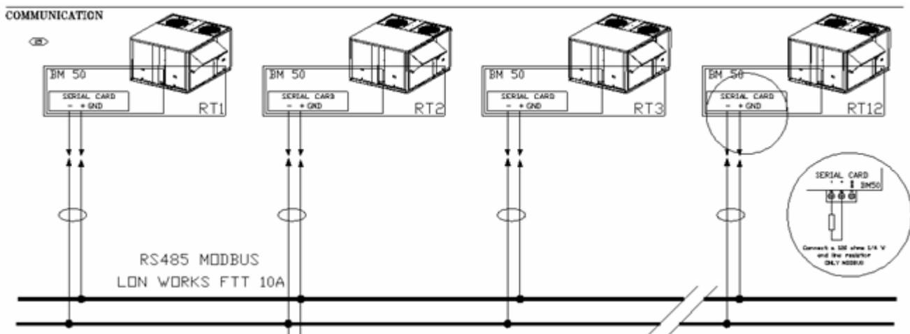
Der Kommunikationsbus wird am BM50 an die Tochterplatine der Climatic™ Serial Card angeschlossen. Eine Sternschaltung ist nicht empfehlenswert, denn für optimalen Betrieb sollten je Gerät maximal zwei Kabel angeschlossen werden.
