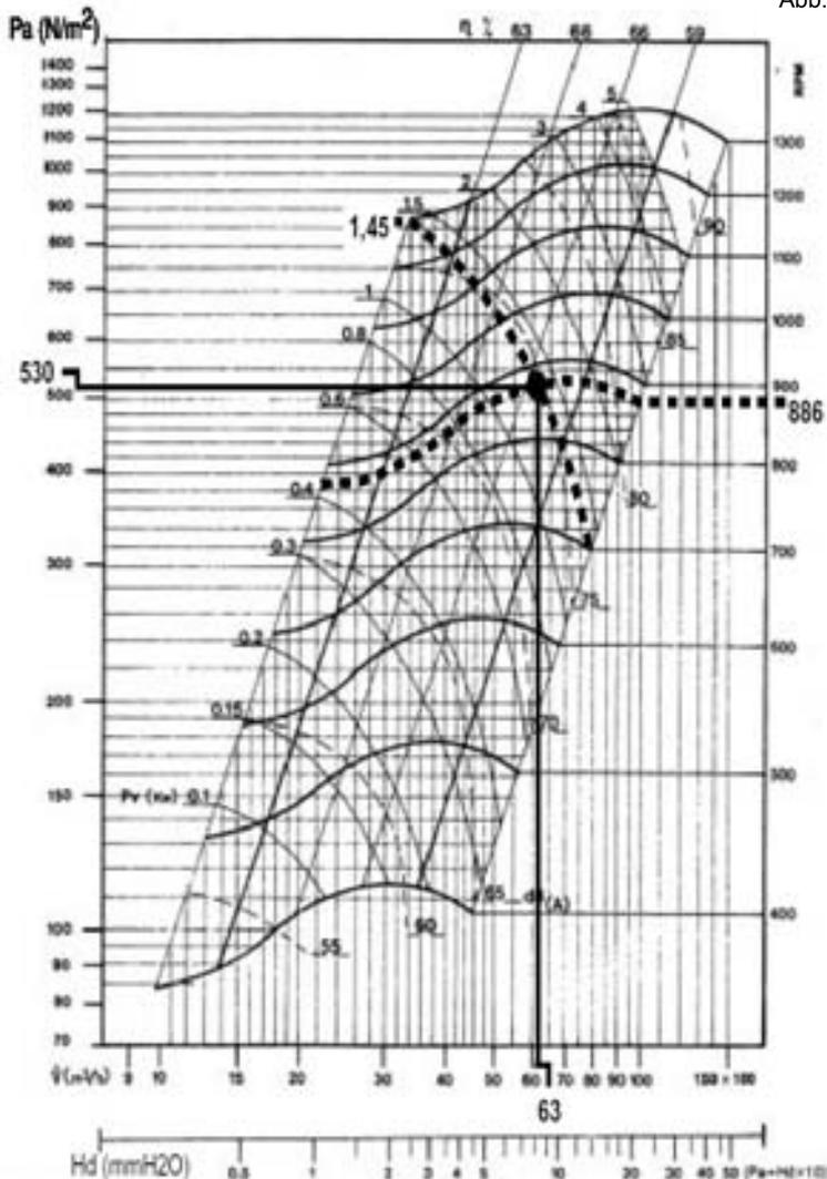
Die Druckverluste in dem Gerät sind die Summe aller Druckverluste in den verschiedenen Teilen des Gerätes:
