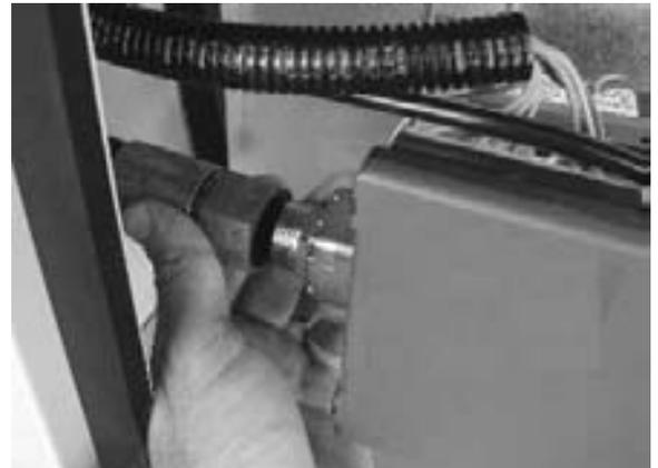
Entlüften Sie die Leitungen einige Sekunden lang in der Nähe des Anschlusses an das Zündsteuerungsventil.
