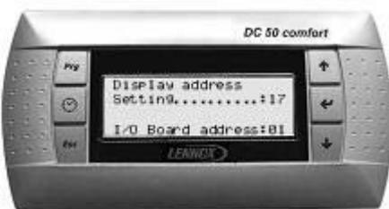
Die Terminaladresse (DC50 oder DM50) muss nach dem Einschalten der Karte überprüft werden.
