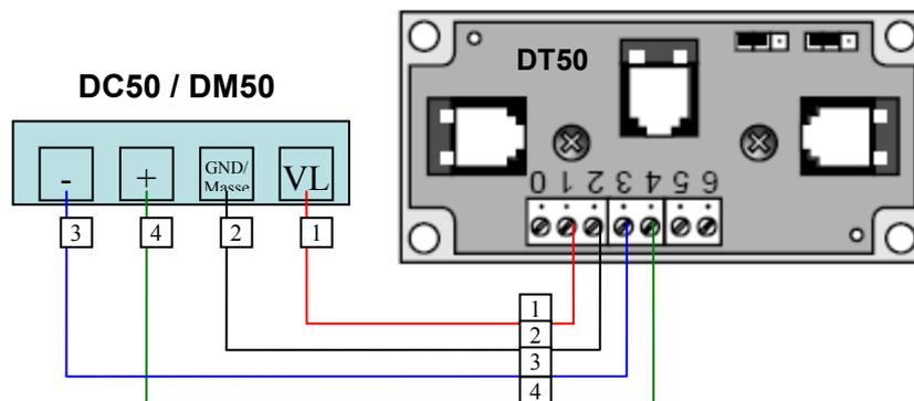
**Terminal-Anschlussplatine Installationsanleitung DT 50**
