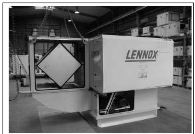
Das Modul auf den Rahmen stellen. Prüfen, ob die schwarzen 20 x 10 Dichtungen in einem guten Zustand sind.
