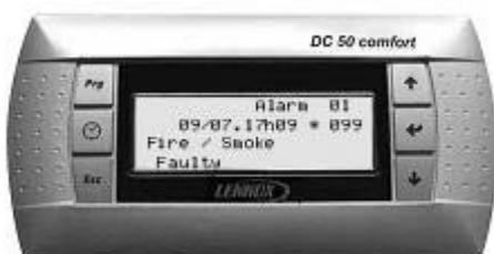
Um den Fehlercode zu markieren, den Cursor mit den Tasten ↑ oder ↓ über der gewünschten Zeile platzieren und mit der Taste 'Enter' bestätigen.
