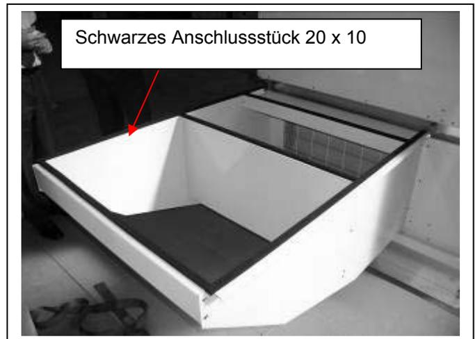
Den Modulrahmen an der Seite des Dachaufsatzes befestigen: 3 rostfreie Schrauben 6 x 20 an beiden Seiten.
