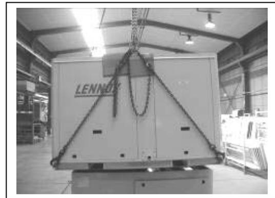
Den Schutz zwischen der Maschine und den Hebeösen verwenden
