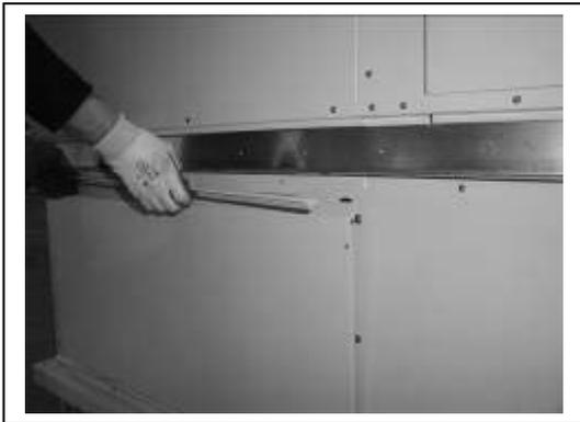
Die Dichtung an der Haubenoberseite aufschneiden und den Winkel abnehmen.
