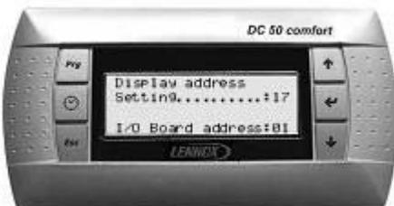
Durch gleichzeitiges Drücken der Tasten ↑ ↓ ↵ mindestens 5 Sekunden lang,
