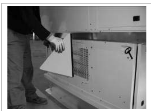
Relever les 2 triangles latéraux de la casquette et dévisser les 3 dernières vis qui serviront à fixer le support de l'échangeur de chaleur.
