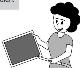
Wenn der Filter verschmutzt ist, waschen Sie ihn in einer Schüssel mit neutraler Seife und Wasser und legen Sie ihn zum Trocknen in den Schatten, bevor Sie ihn wieder in das Gerät einsetzen.
