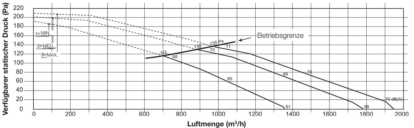
Die als min., med., max. angegebenen Daten beziehen sich auf die drei ab Werk eingestellten Standarddrehzahlen. Auf Wunsch des Kunden können auch drei andere Drehzahlen von den verfügbaren sechs Drehzahlen angeschlossen werden.
