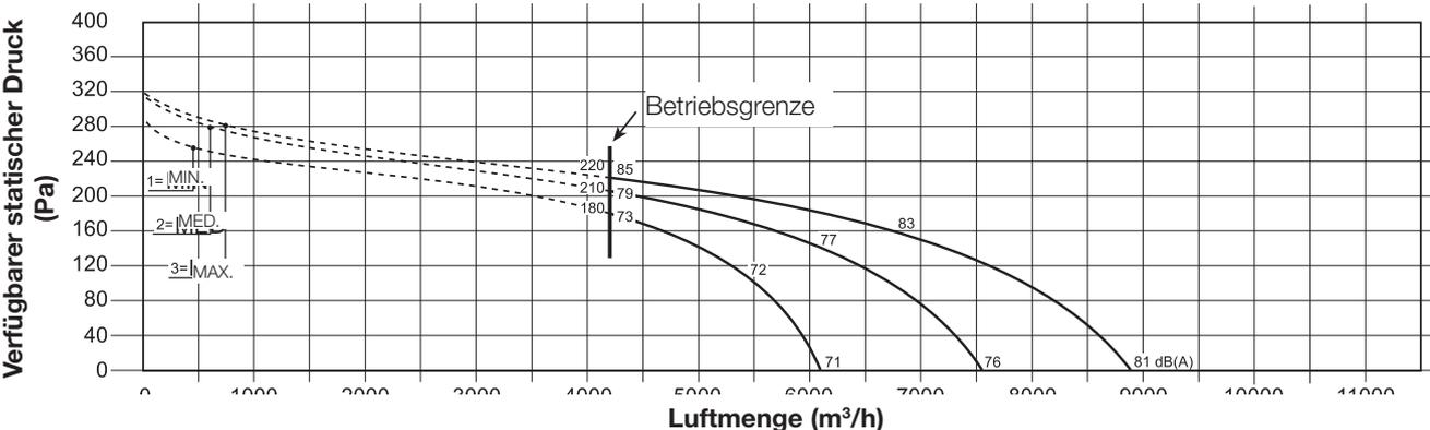
Die als min., med., max. angegebenen Daten beziehen sich auf die drei ab Werk eingestellten Standarddrehzahlen. Auf Wunsch des Kunden können auch drei andere Drehzahlen von den verfügbaren sechs Drehzahlen angeschlossen werden.
