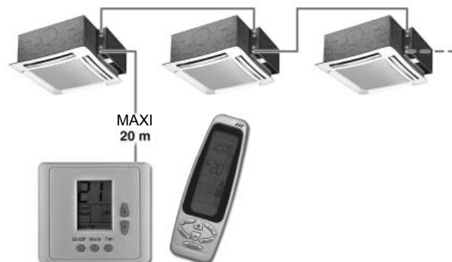
Une commande pour plusieurs cassettes (20 unités au maximum) (Longueur totale maxi du fil de raccordement = 800 m)
