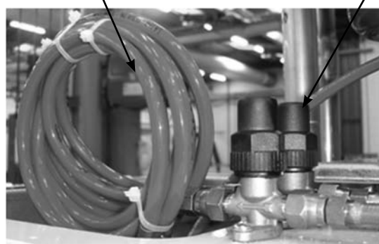
Hogedrukleidingen klaar voor aansluiting op het ventiel
