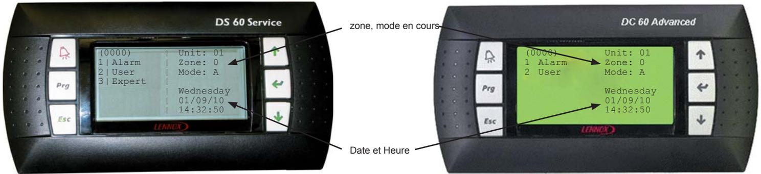
Pour accéder à l'historique des alarmes, appuyer sur le bouton "Alarme" lorsque vous êtes dans le menu (0000). Le CLIMATIC 60 sauvegarde les 32 dernières alarmes. Une alarme active est signalée par le symbole "Alarme" alors qu'une alarme inactive est symbolisée par le "."
