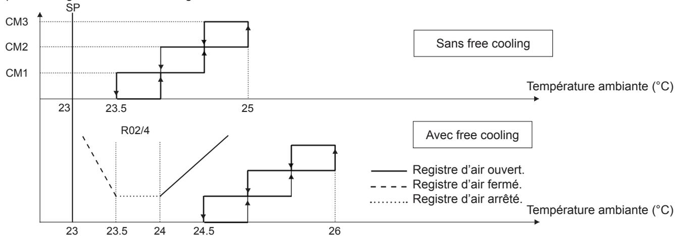
Pour obtenir un renouvellement permanent de l'air, le registre peut être partiellement ouvert (20%), selon les paramétrages suivants.
