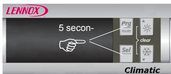
a) Appuyer simultanément sur les touches « Pgr » et « Sel » pendant 5 secondes.
