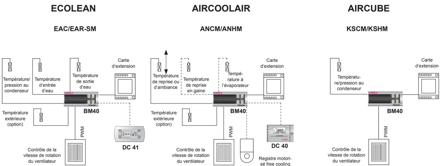
Sondes de température d'entrée et sortie d'eau, de température/pression au condenseur et de température d'air extérieur (option).
